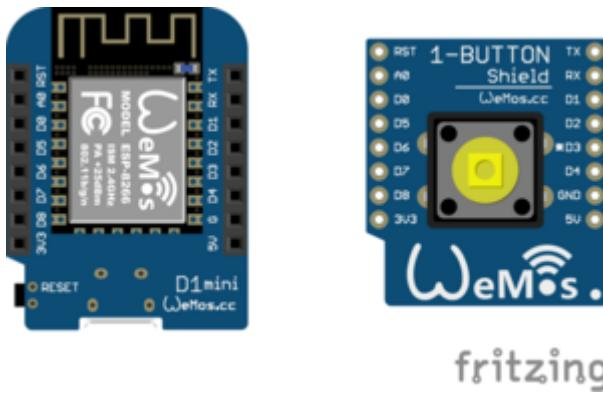
Simplemente ponemos el button Shield encima del Wemos verificando que coinciden las patillas de cada módulo.
