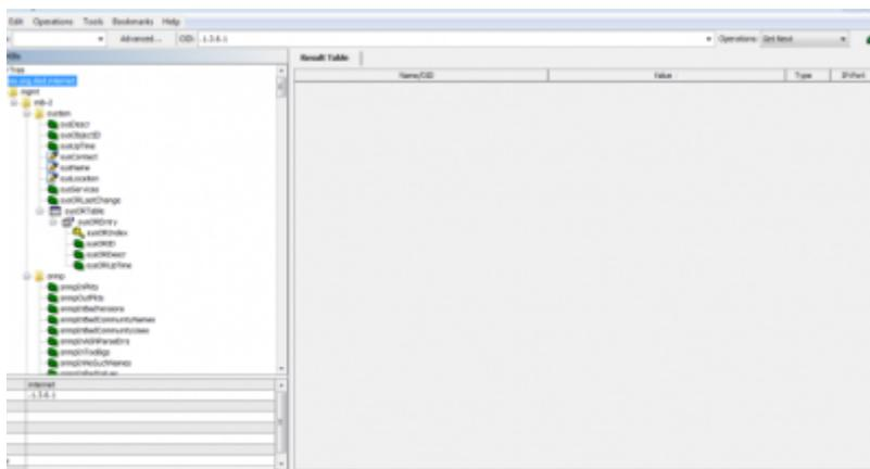
También podemos utilizar el comando **SNMPWALK** que nos mostrará todos los OID y los compara con los datos del MIB, además mostrará los datos de aquellos que coincidan.
