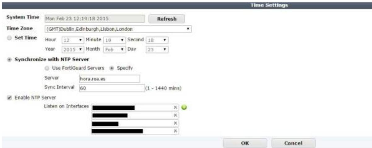
Para comprobar si se está sincronizando ejecutamos en la consola `diag sys mtp status` el resultado será algo como `synchronized: no, ntpsync: enabled, server-mode: disabled`
