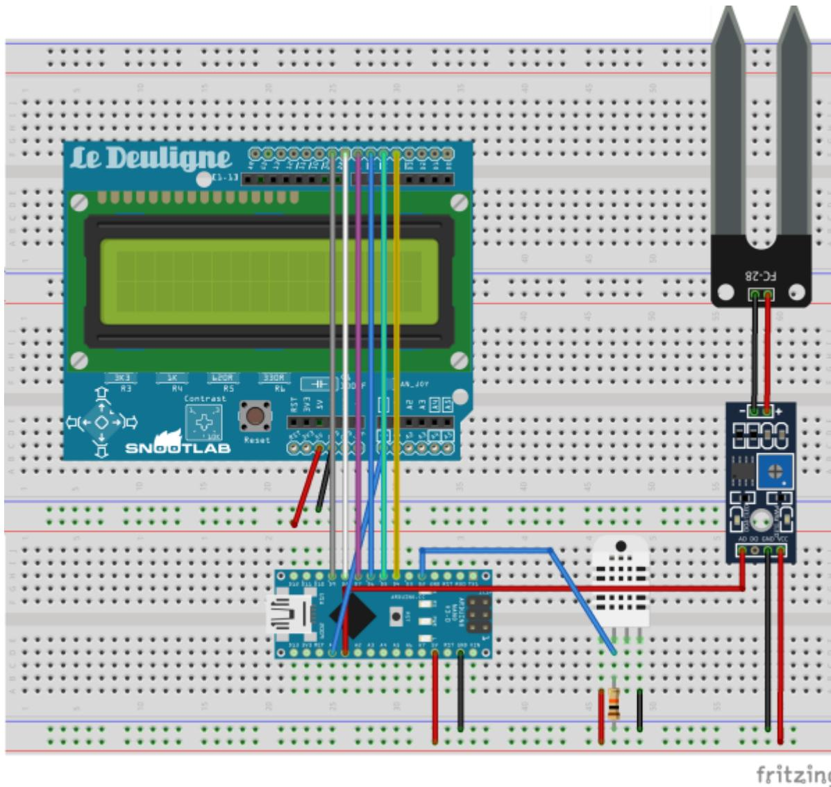
El esquema de conexión sería: A0 del LCD → A0 del nano D4 LCD → D4 nano D5 LCD → D5 nano D6 LCD → D6 nano D7 LCD → D7 nano D8 LCD → D8 nano D9 LCD → D9 nano
